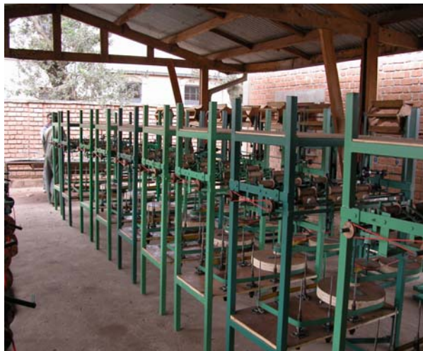
Figure 6 : EMSF – Bassines de filatures, moulins et doubleuses-reflotteuses améliorées en attente d’être réparties chez des opérateurs pilotes
